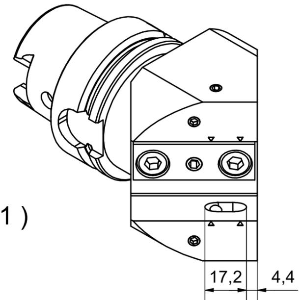
verschließbar mit M5x5 - DIN 913
